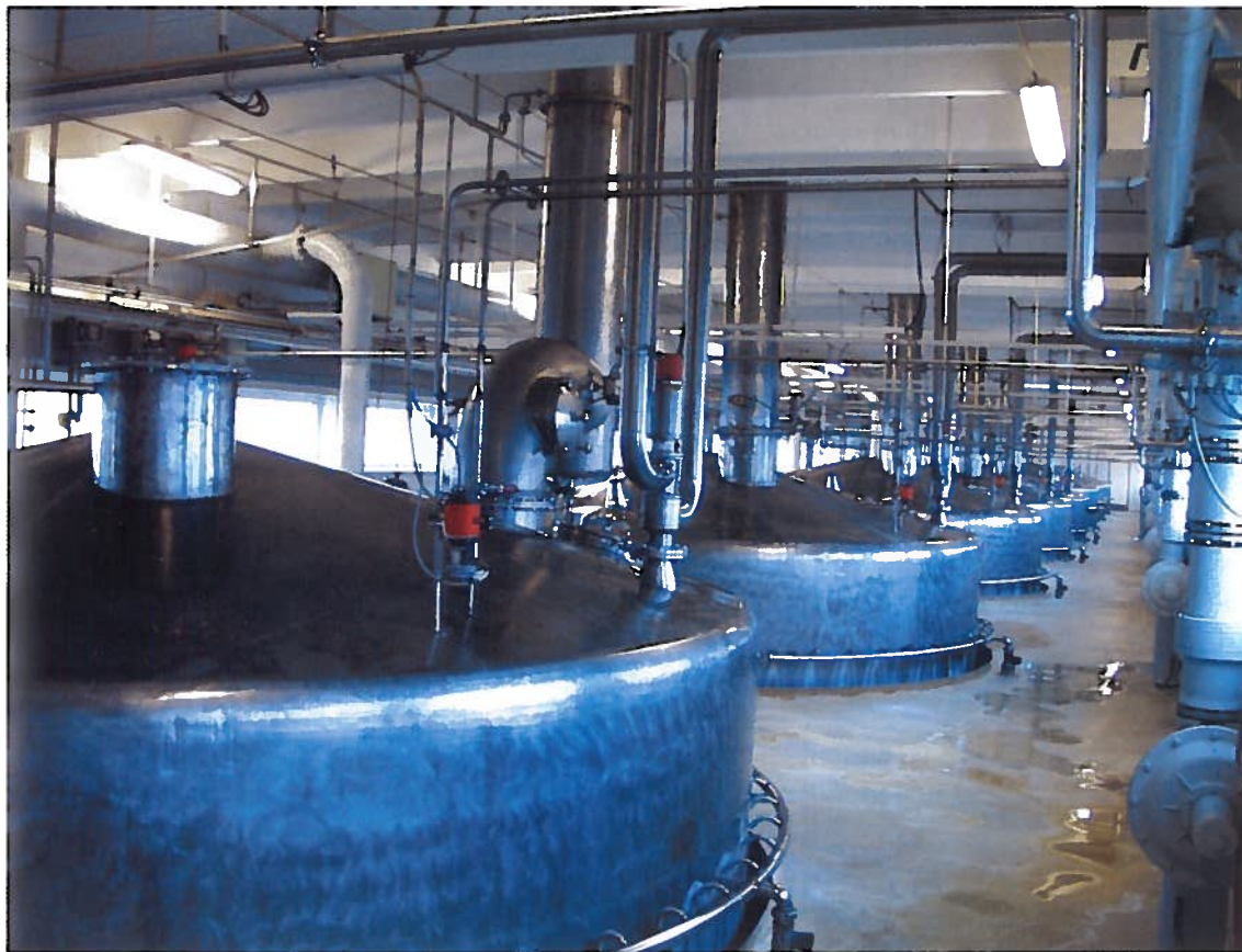
På De Danske Spritfabrikker foregår både alkohol- og gærfremstilling i store gæringstanke (delvis skjulte).
