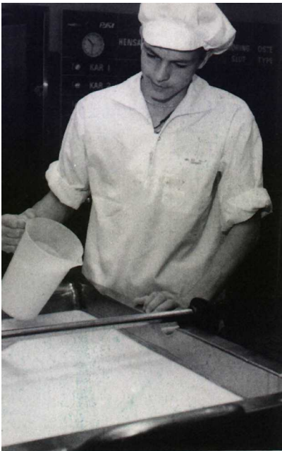
Tilsætning af osteløbe til mælk for at få mælken til at danne ost. Osteløbe er udtræk (enzym) fra kalvemaver.
